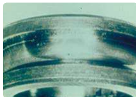
Этап 2: Появление и развитие микротрещин на поверхности. Затем возникает микровыкрашивание.
