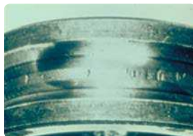
Этап 3: Перекатывание загрязнений, развитие выкрашивания поверхности.
